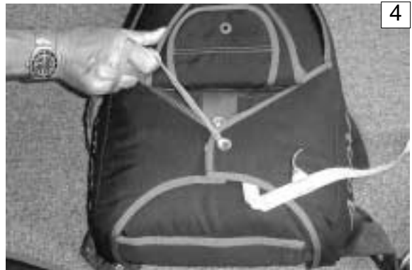
4 Fermer le rabat droit par dessus la drisse d'extracteur. Close the right flap over the pilotchute bridle.
