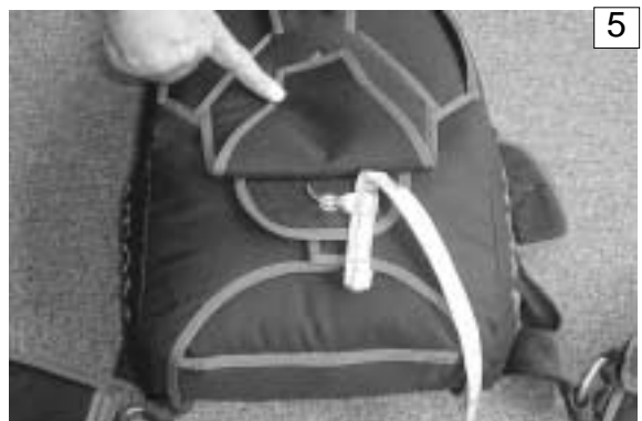
5 Fermer le rabat supérieur et verrouiller le container à l'aide de l'aiguille courbe. Close the upper flap and secure container with curved closure pin.
