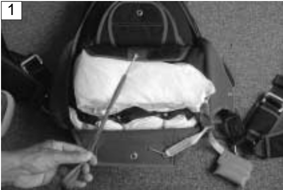
1 Refermer le rabat intérieur par dessus le Pull-out. Close the inner flap over the Pull-out.
