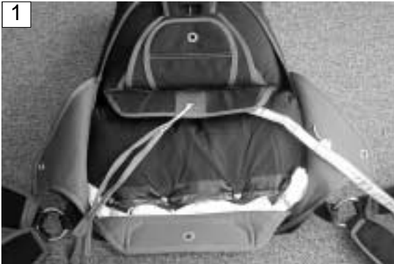
1 Dégager la drisse d'extracteur vers la droite. Route the pilotchute bridle to the right side.
